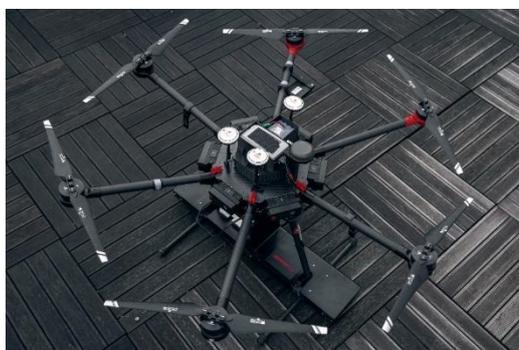
Skipper NDT Drone avec une barre en fibre de carbone spécialement conçue pour intégrer des capteurs de mesure.
